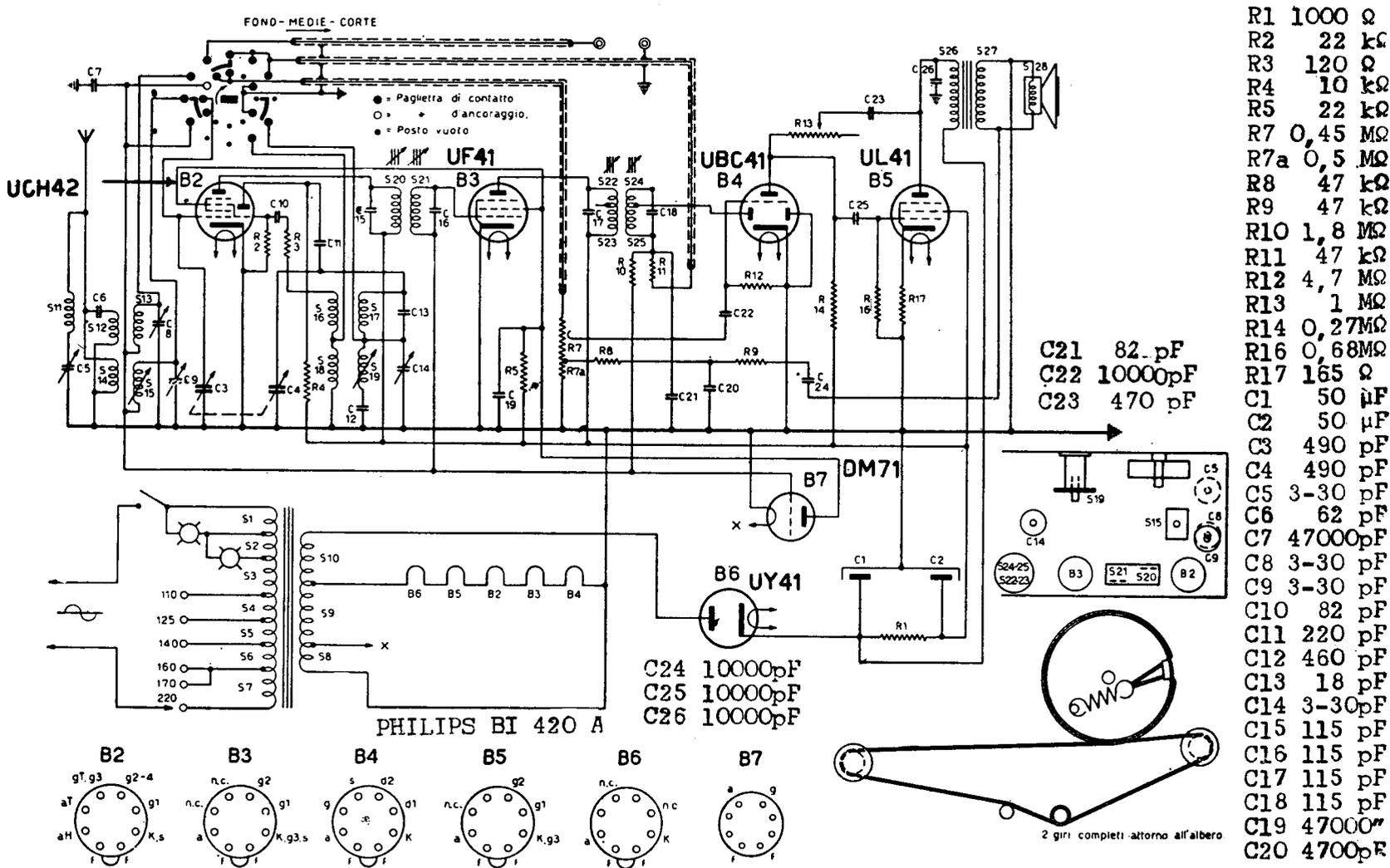
PHILIPS RADIO - Mod. BI 420 A. Una gamma onde medie da 184 a 545 m, ed una ad onde corte da 16,5 a 50 m. Media frequenza 467 kc/s. Corrente anodica totale 71 mA. Consumo 46 watt.
